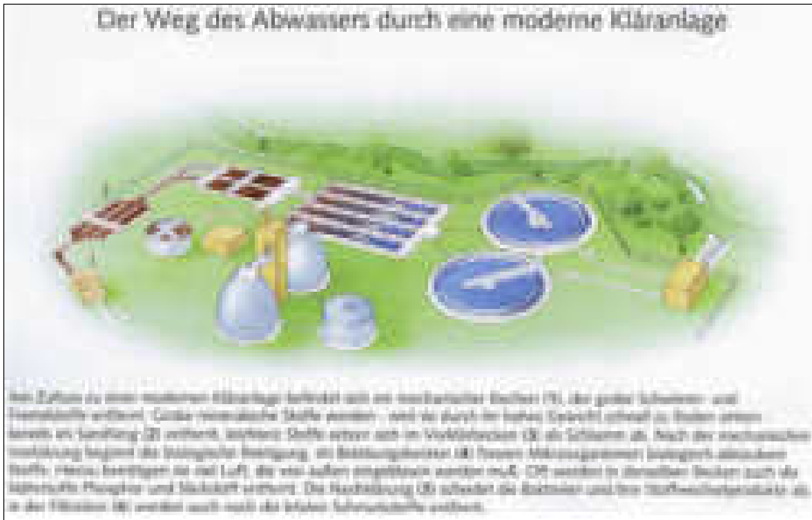
Abbildung 11.1.1: Aufbau einer Kläranlage (Quelle: Wasserwirtschaftsamt Kempten: www.wwa-ke.bayern.de )
